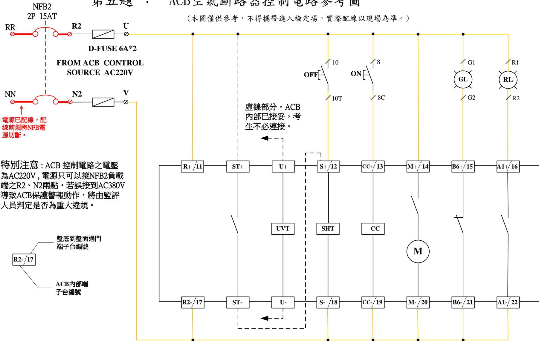
特別注意：ACB 控制電路之電壓為AC220V，電源只可以接NFB2負載端之R2、N2兩點，若誤接到AC380V導致ACB保護警報動作，將由監評人員判定是否為重大違規。
