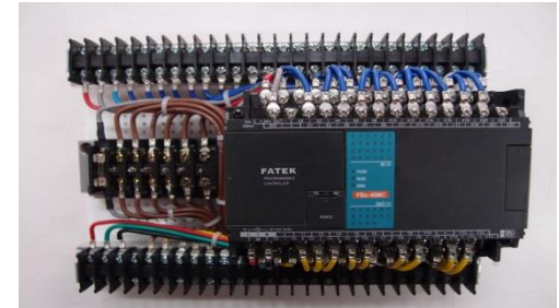
PLC含特製端子 氙燈短路保護
